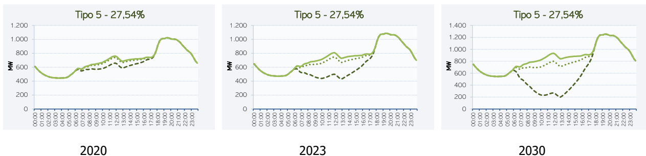
Figura 40: Tipo 5 das Redes MT Urbanas da CEMIG D com inserção de Micro GD Local
