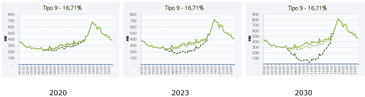
Figura 32: Tipo 9 dos Transformadores MT/BT da CEMIG D com inserção de Micro GD Local
